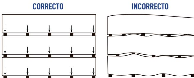
Para el apilamiento de las placas GypTech ST, colocar 5 apoyos mínimo, uniformemente distribuidos a lo largo de la placa y que coincidan con los inferiores. Estos apoyos deben coincidir cuando se apila más de un pallet para evitar deformación del material.
